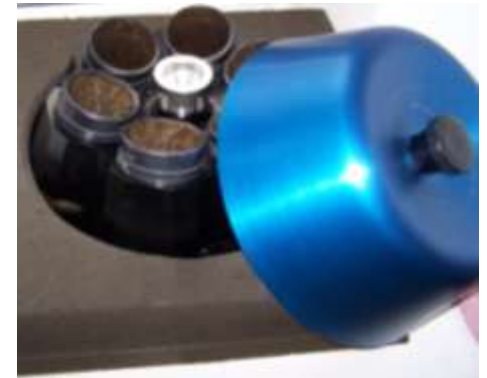
Preparatív centrifuga és szög-rotorja (2,5 L-ig)
