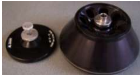
Szemipreparatív hűthető centrifuga Eppendorf és szemipreparatív rotorral ( g_{max}=30\ 000g )
