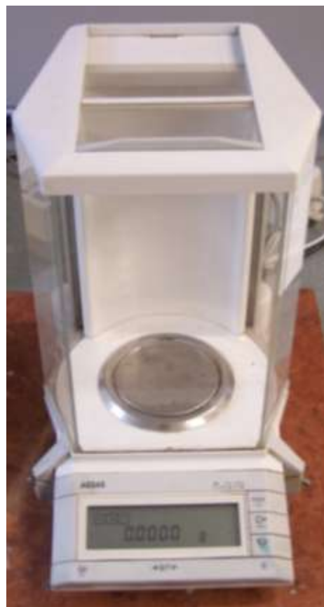
Analitikai mérleg (0.01mg-40g) rezgésmentes asztalon
