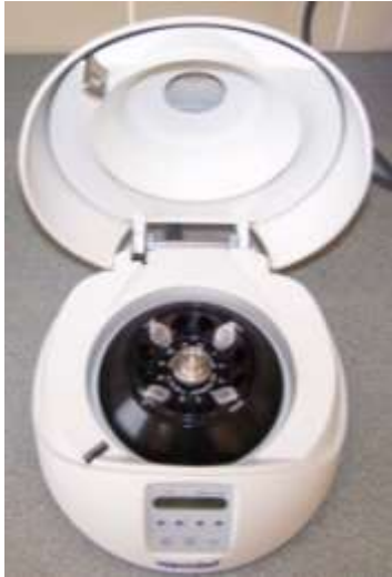
Asztali Eppendorf centrifuga Max. fordulatszám 14 0001/perc)
